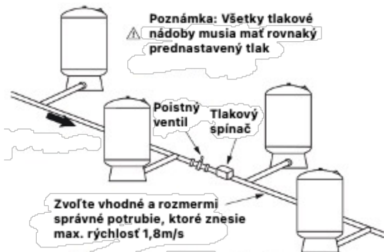
Obr. 1.5 Inštalácia viacerých tlakových nádob
